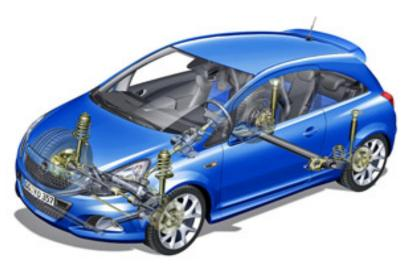
Los amortiguadores proporcionan seguridad y comodidad durante la conducción y da estabilidad al coche. La forma de absorber las irregularidades son: Mecánica, en este caso los desplazamientos de las ruedas son absorbidas por muelles. Hidráulica, en este caso los conjuntos hidráulicos soportan los desplazamientos de las ruedas. Hidroneumática, es la acción combinada de un líquido y un gas, para soportar los desplazamientos de las ruedas.
