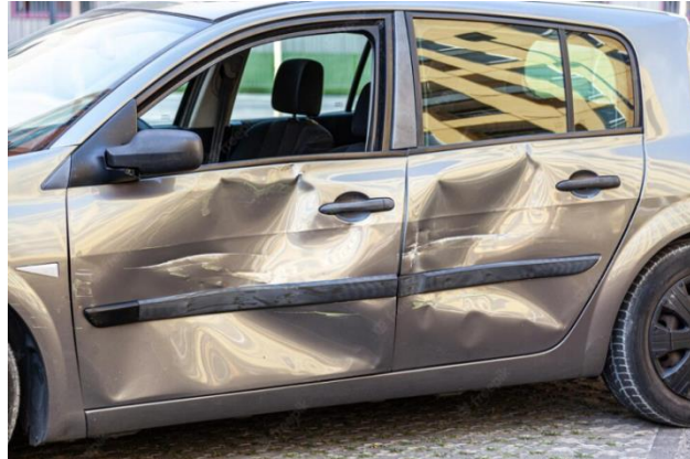
Figura 3: Abolladura lateral (elaboración propia).
