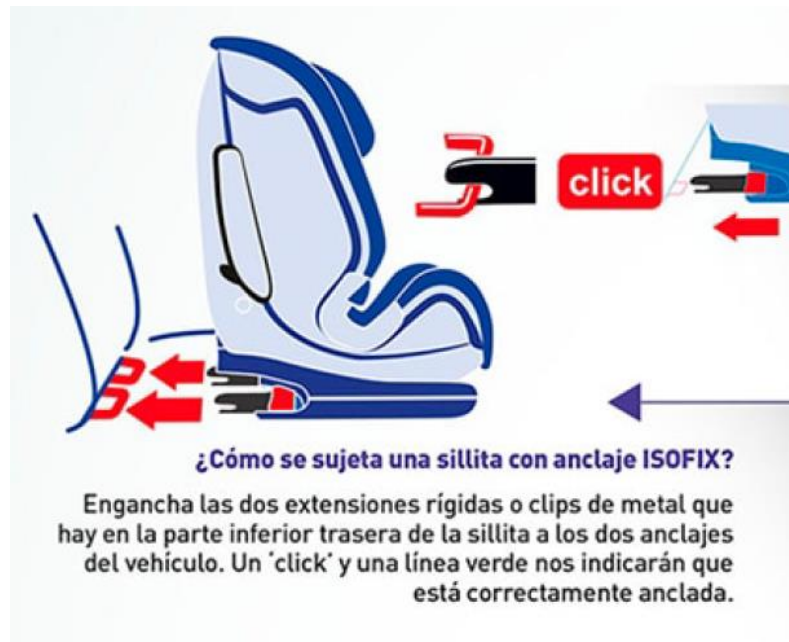
(Figura 13). Instalación del SRI a través del sistema Isofix.
