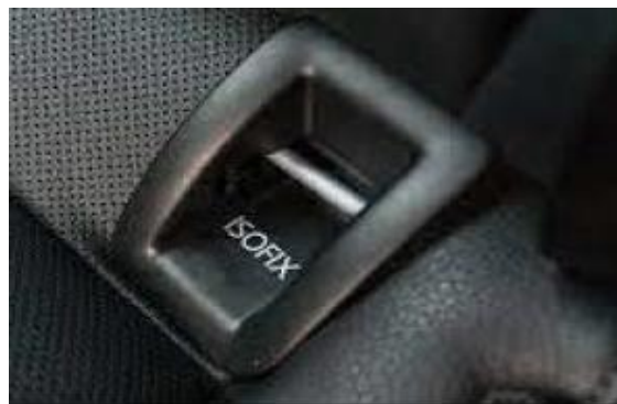
(Figura 12). Uno de los dos anclajes Isofix situado entre el respaldo y el asiento del vehículo.
