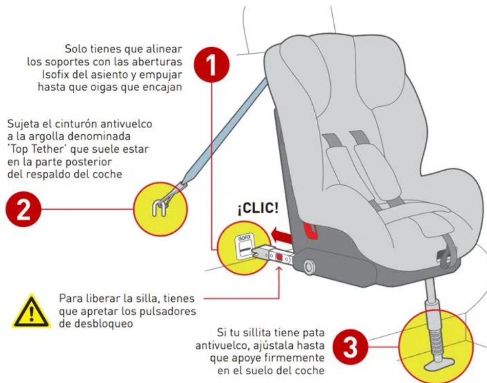
(Figura 14). SRI con anclaje Isofix (1), Top Tether (2) y pata de apoyo antivuelco (3).
