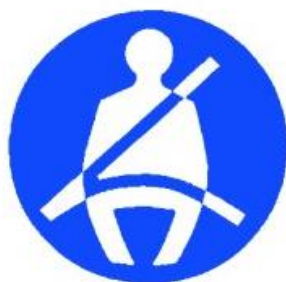
(Figura 17). Pictograma indicativo del uso obligatorio del cinturón de seguridad conforme al Real Decreto 965/2006, de 1 de septiembre.
